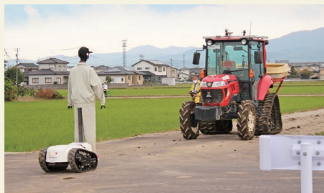
10月のロボットトラクター実演会の様子。マネキン型ロボットを検知すると自動で停止する(富山市)
