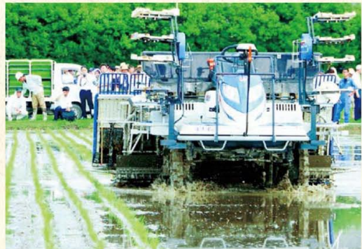
農研機構が披露したロボット田植え機 リモコンで発進停止、速度を指示する
