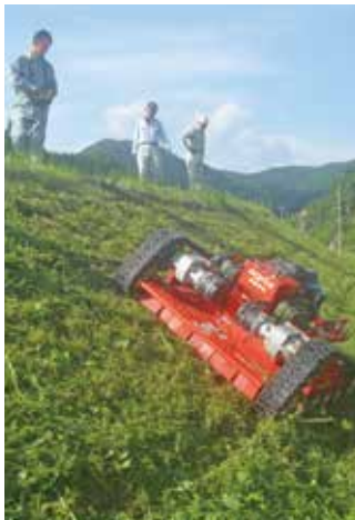
40度を超える急傾斜をすいすいと進む自走型草刈り機（島根県雲南市で）
