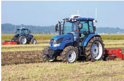
2台同時で耕起作業するロボットトラクター (千葉県横芝光町)
