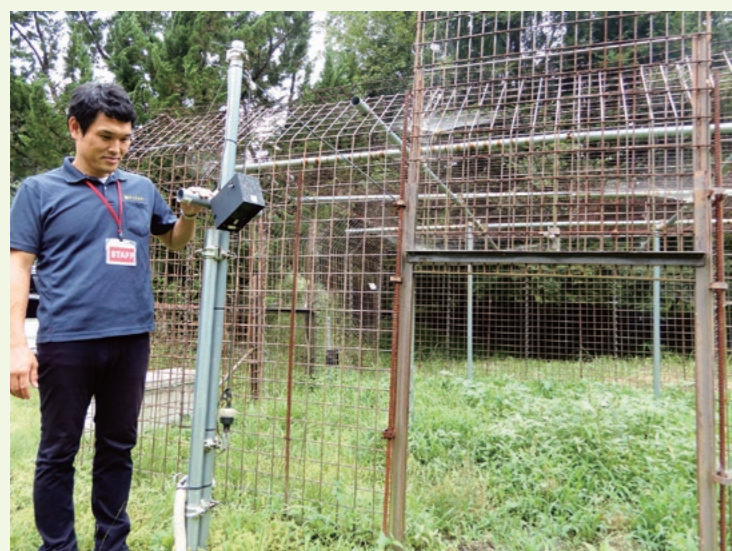
わな入り口に置いた温度センサーで、外にいる害獣を検知する(三重県伊賀市で)
